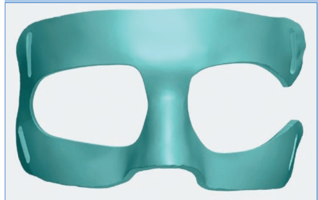
FIG. 4. Fase CAD. a) Diseño del margen del protector facial, vistas frontal y laterales. Se tiene en cuenta la apertura para los ojos.
